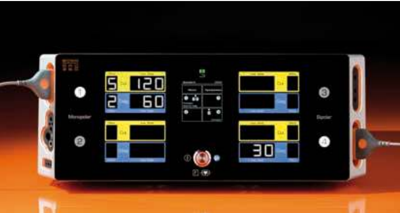
Понятность: каждый подключенный разъем – на изображении верхний левый и нижний правый разъемы – соотносен с одним квадрантом экрана
