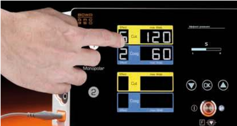
Простота управления: Для настройки эффектов или значений мощности достаточно прикоснуться к соответствующему полю, после чего активируется меню ввода данных в центре ARC 350
