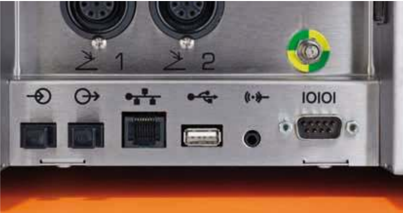
Интерфейсы связи: с USB-портом и сетевым соединением для использования сегодня и в будущем
