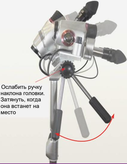
8D. Поворачивайте рукоятку тонкой регулировки высоты, чтобы осторожно перемещать головку вверх или вниз. Используйте ручку грубой регулировки высоты для более значительного изменения высоты.
