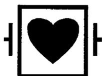
Рабочая часть типа CF с защитой от воздействия дефибриллятора (по ГОСТ Р 50267.0 и ГОСТ Р 50267.25)
