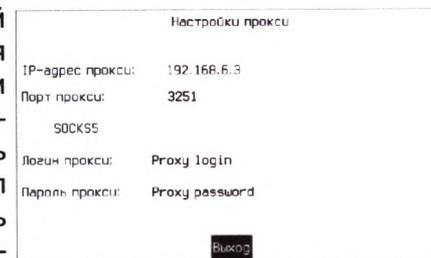
Кнопка «SOCKS5» позволяет включить поддержку сетевого протокола Socket Secure 5, который иногда используется в сетях с прокси-сервером.
