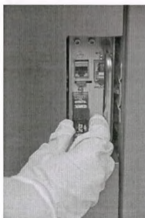
Рисунок 42. Вставьте запоминающее устройство в USB-порт.
