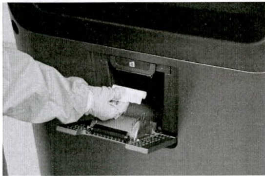
Рисунок 37. Извлеките пустой рулон бумаги.
