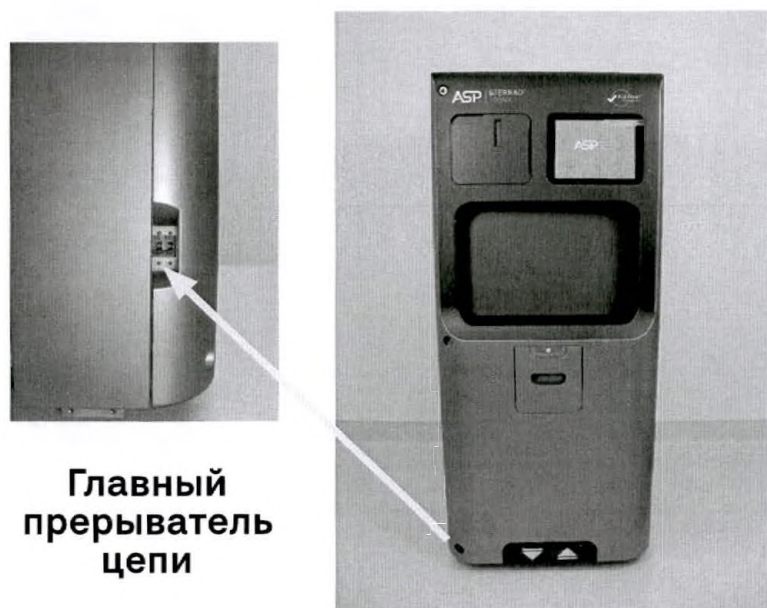
Рисунок 43. Основной выключатель питания/прерыватель цепи расположен на стерилизаторе слева по отношению к оператору.
