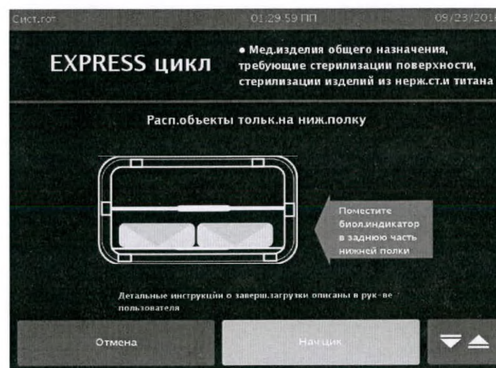
Рисунок 16d. Загрузите камеру для цикла EXPRESS.
