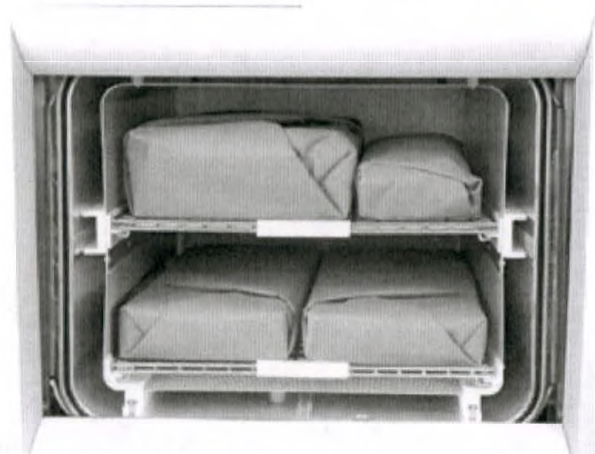
Рисунок 8. Правильно размещенные стерилизуемые объекты для обработки в СТАНДАРТНОМ (STANDARD) цикле.
