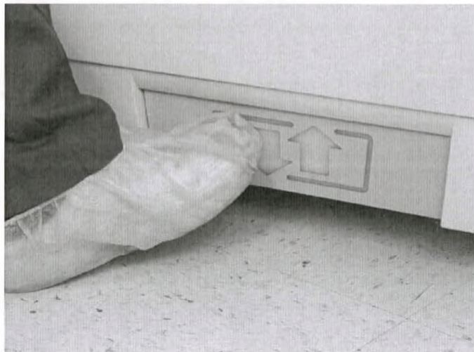
Рисунок 4. Нажмите на ножной переключатель, чтобы открыть дверцу.
