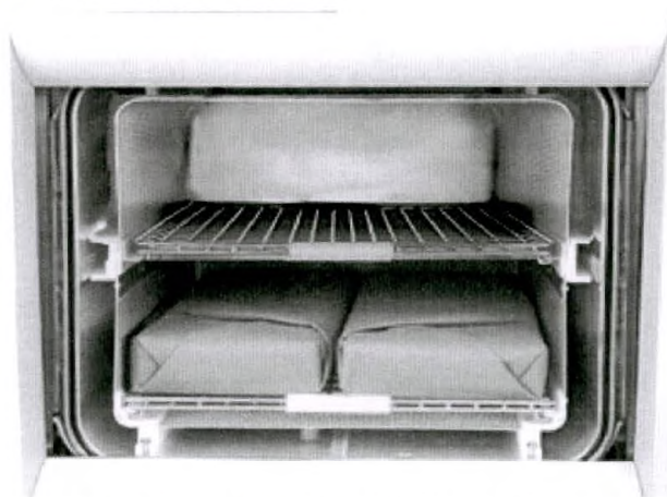
Рисунок 10. Правильно размещенные стерилизуемые объекты для обработки в УСКОРЕННОМ (EXPRESS) цикле.
