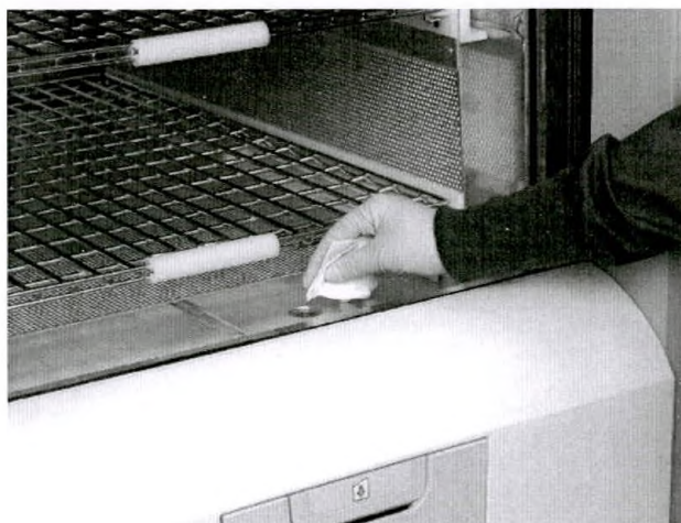
Рисунок 33. Чистка линзы детектора перекиси водорода.
