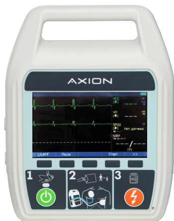
Дефибриллятор ДА-Н-02 с функцией ручной и автоматической наружной дефибрилляции.
