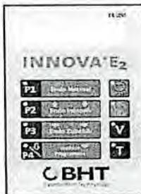
Для устранения эксплуатационных ошибок, активируются только определенные кнопки в зависимости от эксплуатационного состояния машины. Активированные кнопки подсвечиваются светодиодом в левом верхнем углу кнопки.
