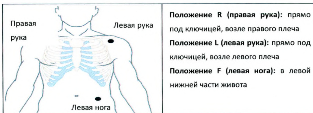
Рисунок 12-1 Схема размещения электродов с тремя отведениями
