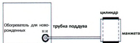
Рис. 16-6 Соединения для проведения испытания утечки НИАД
