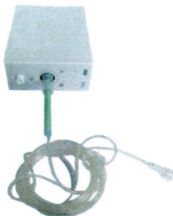
Рисунок 13- Схема подключения модуля CO 2 «Масимо» (Masimo) для модуля CO 2 бокового потока, «Масимо»
