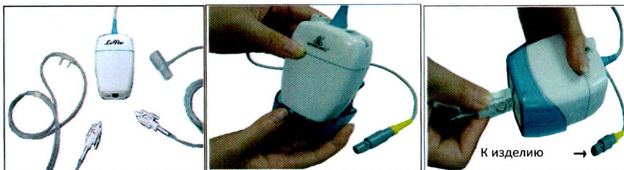
Рисунок 13-4 Схема подключения модуля CO 2 бокового потока «Респироникс» (Respironics)
