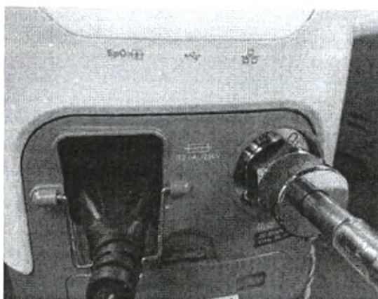
Рис. 3-2. Схема подключения источника O_2 для NF2/NF3/NF5
