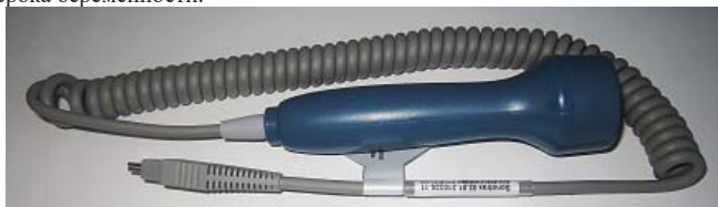
Рисунок 2-7. 2.0 / 3.0 МГц акушерский датчик
