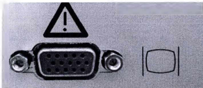
Рисунок 8: VGA-разъем для подсоединения внешнего монитора (дооснащение)
