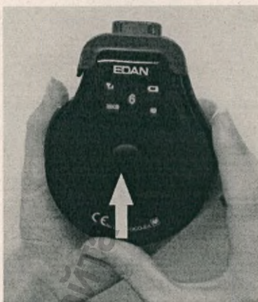
Рисунок 59 Установка муфты электрода
