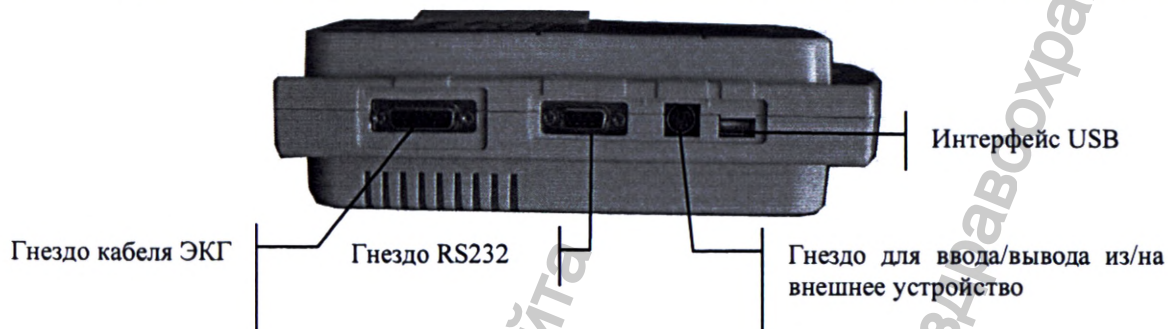
Рис. 2-5. Разъемы электрокардиографов SE-300A, SE-300B, SE-3
