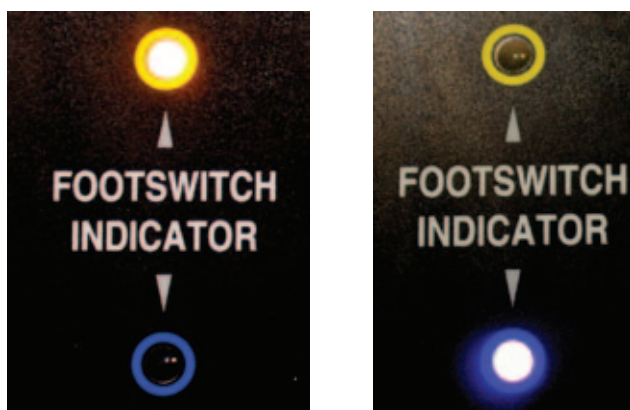
Рис. 24. Активирована ножная педаль режимов разреза «Cutting Mode» (слева). Активирована ножная педаль режимов коагуляции «Coagulation Mode» (справа)
