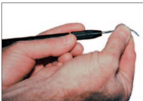
Рис. 45. Фиксация электрода в наконечнике
