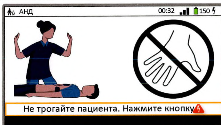
Рисунок 7.6 — Готовность к подаче разряда
