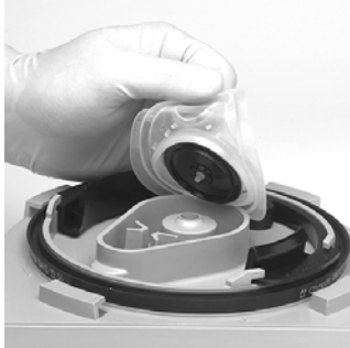
Рисунок 9-19: Снятие выпускного клапана давления.
