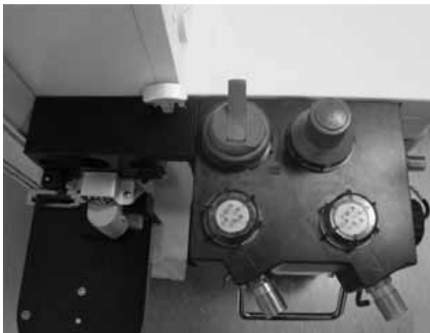
Рисунок 9-28: Фиксация модуля дыхательного контура
