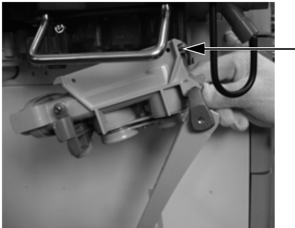
Рисунок 9-36: Повторная установка модуля на дыхательный контур
