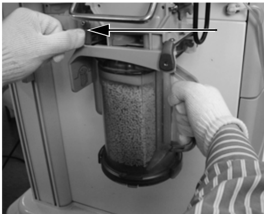
Рисунок 8-3: Разблокировка рамы канистры
