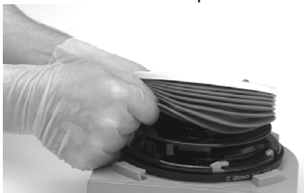
Рисунок 9-17: Снятие нижнего края мехов
