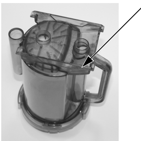
Рисунок 3-2: Проверка канистры абсорбера
