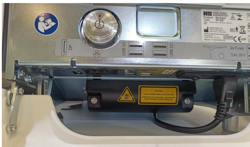
Рис. 4.2 – подключение кабеля питания к Eyestar ES 900
