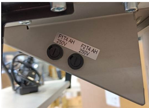
Рис. 3.2 – 2 отсека для предохранителей в блоке управления стола инструментального
