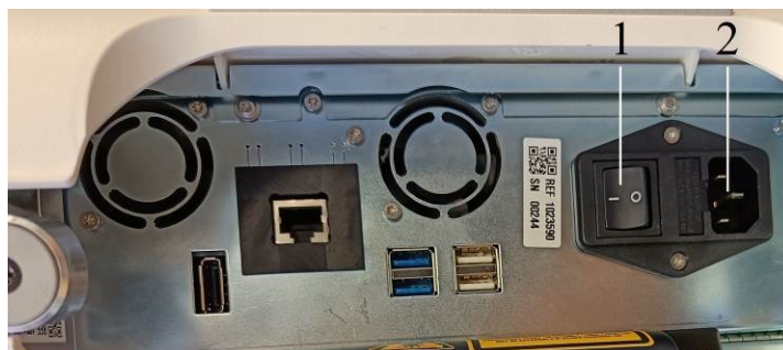
Рис. 6.1 – сетевой выключатель устройства (1) и разъем кабеля питания (2)
