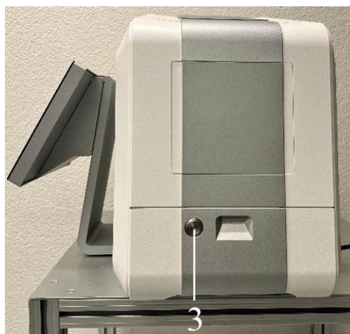
Рис. 6.2 – кнопка включения (3) в корпусе устройства
