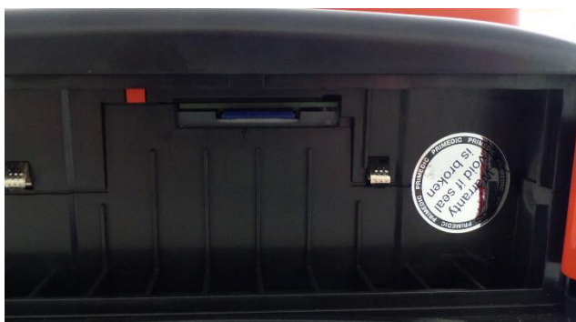
Рис. 12: Установка / извлечение карты памяти SD
