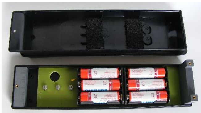
Рис. 9: Модуль питания в открытом состоянии
