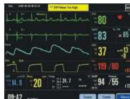
Диагностические измерения и мониторинг, включая ЭКГ, SpO<sub>2</sub>, НИАД, температуру, дыхание, ИАД и CO<sub>2</sub> в конце выдоха.
