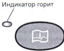
В ручном режиме индикатор **АВТО/РУЧН** не горит. Нажмите на клавишу **СТАРТ/СТОП**, чтобы начать запись кривых ЭКГ в ручном режиме.
