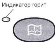
**5** Выберите запись в реальном времени или в режиме просмотра с помощью клавиши **СТАРТ/СТОП** (запись в реальном времени) или функциональной клавиши [Просмотр] (запись в режиме просмотра). Электрокардиограф начнет автоматическую регистрацию кривых ЭКГ с переключением групп отведений.
