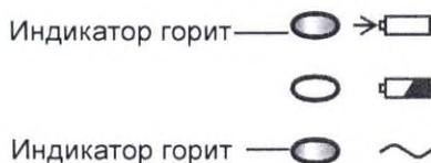
Батарея аккумуляторная заряжается, когда электрокардиограф подключен к сети переменного тока, а клавиша **ПИТАНИЕ** не нажата. Время зарядки батареи аккумуляторной 10 часов. Полностью заряженная батарея аккумуляторная позволяет выполнять непрерывную регистрацию в течение около 60 минут.
