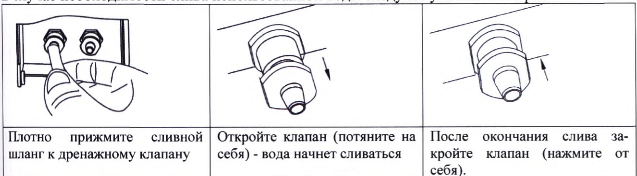
Рис. 4. Порядок слива использованной воды из бака стерилизатора.
