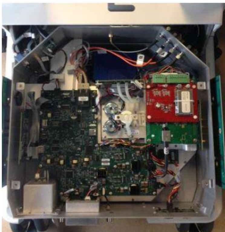
Рисунок 20. Платы: контрольные, интерфейсные, индикаторные распределительные, управляющие (являются внутренними элементами системы).
