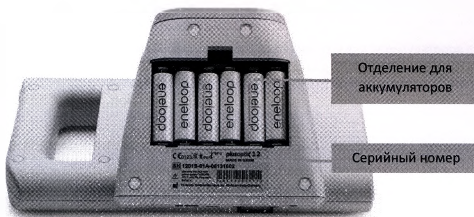
Рис.4. Нижняя сторона прибора (plusoptiX A12C).
