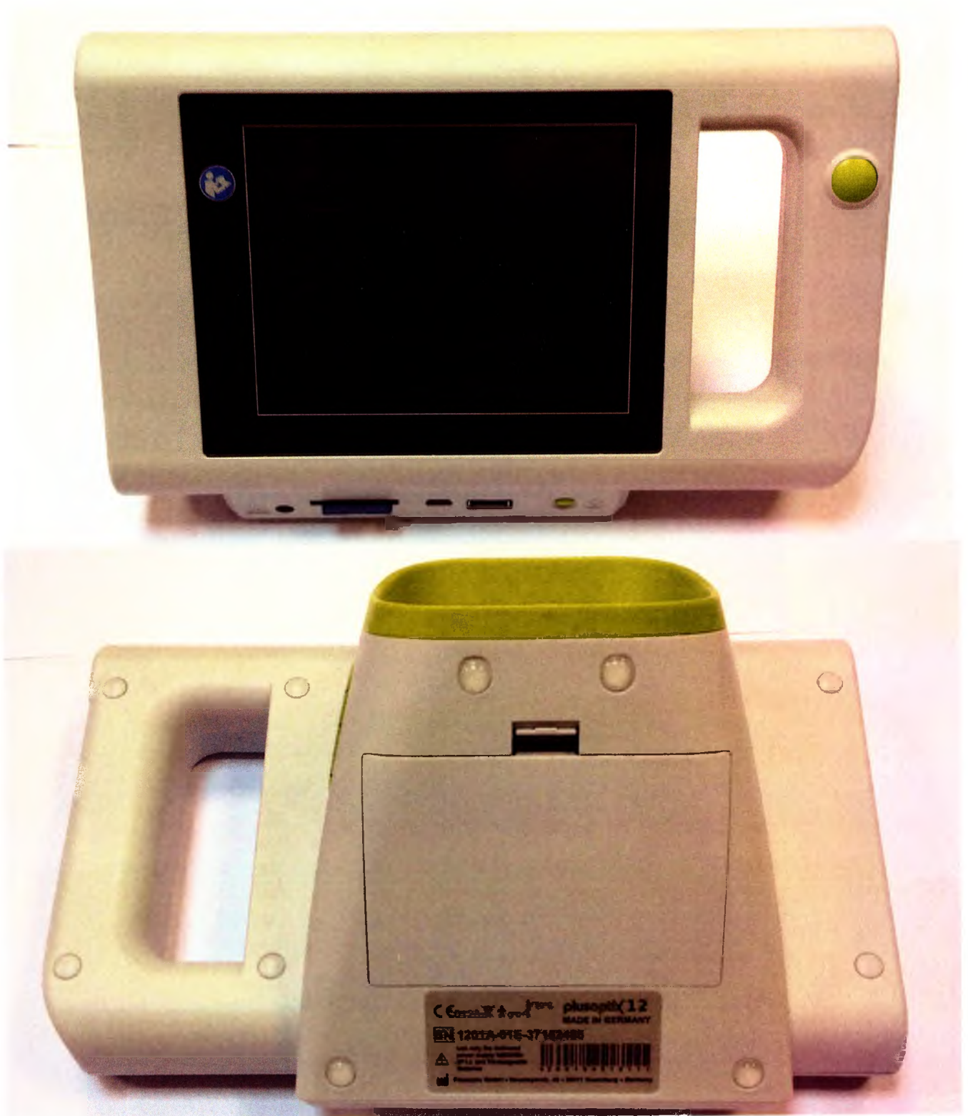
Авторефрактор переносной педиатрический plusoptiX модель 12, вариант исполнения plusoptiX A12C
