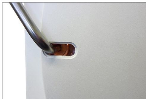
5. Поворачивайте торцевой шестигранный ключ против часовой стрелки, пока дверца не откроется.
