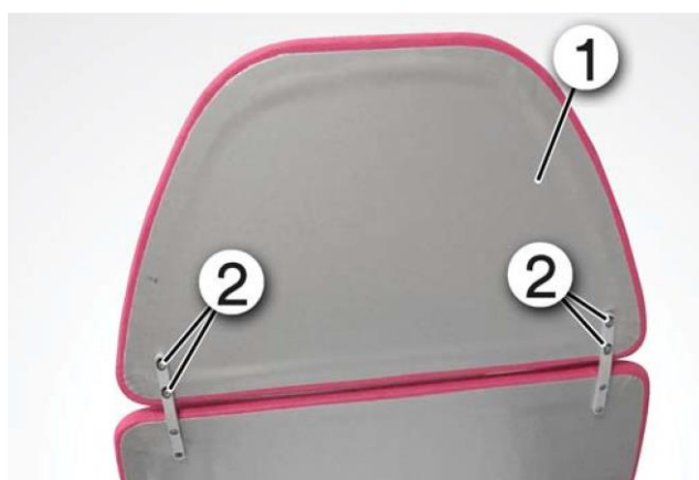
Рис. 52 Снятие подголовника 1) Подголовник 2) Установочные винты
