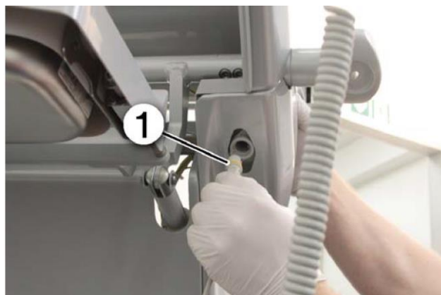
Рис. 30 Подключение вилки соединительного кабеля к ручному пульту управления 1) Вставить соединительный кабель в ручной пульт управления
