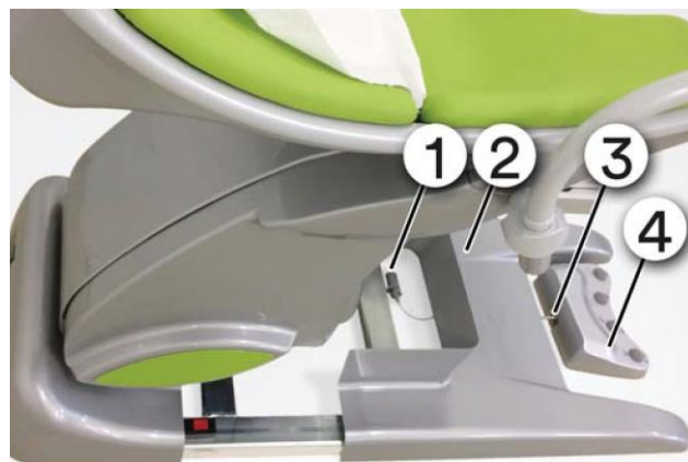
Рис. 24 Протягивание соединительного кабеля под крышкой опоры 1) Розетка 2) Крышка фронтальной опоры 3) Соединительный кабель 4) Ножная педаль управления
