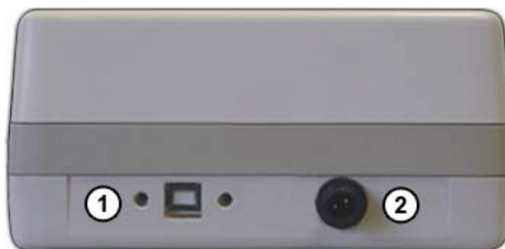
1. Разъем для подключения шины USB;
