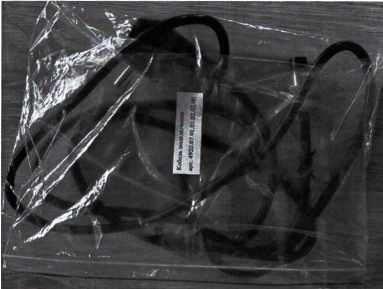
Маркировка кабеля подключения
