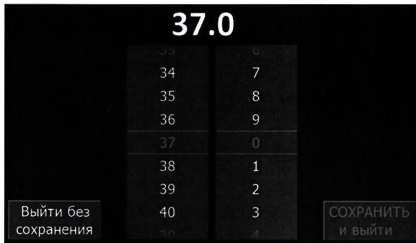
Рис.92. Настройка температуры промывочной жидкости
