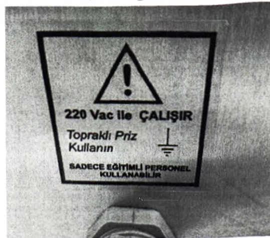
Рисунок 3 - Предупреждающая этикетка кабеля электропитания (1) Работает только на 220 В Используйте заземляющую вилку К работе допускается только обученный (квалифицированный) персонал
