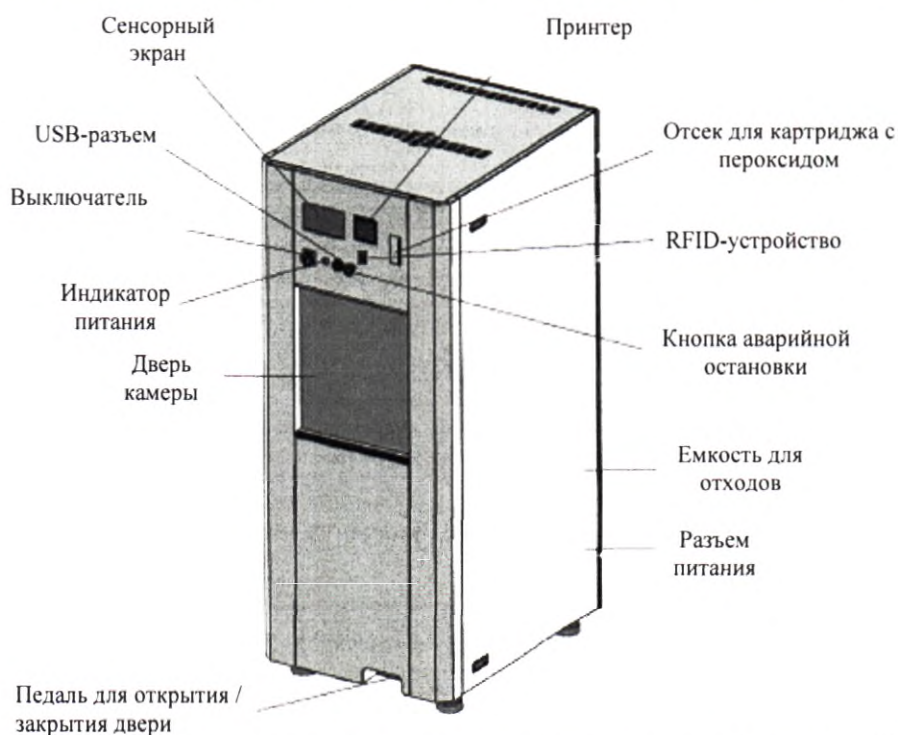
Рисунок 14 – Общая схема низкотемпературного плазменного стерилизатора HRF 3000 с принадлежностями (расположение комплектующих стерилизатора на схеме может отличаться от реального)
