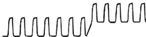
Рисунок 2-31. Скачкообразный подъем уровня капнограммы при попадании влаги на оптические элементы
