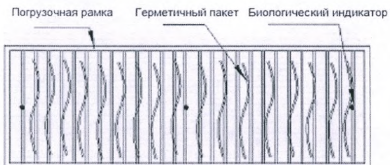
Рисунок 12 Герметичная пленка и схема расположения биологических индикаторов
