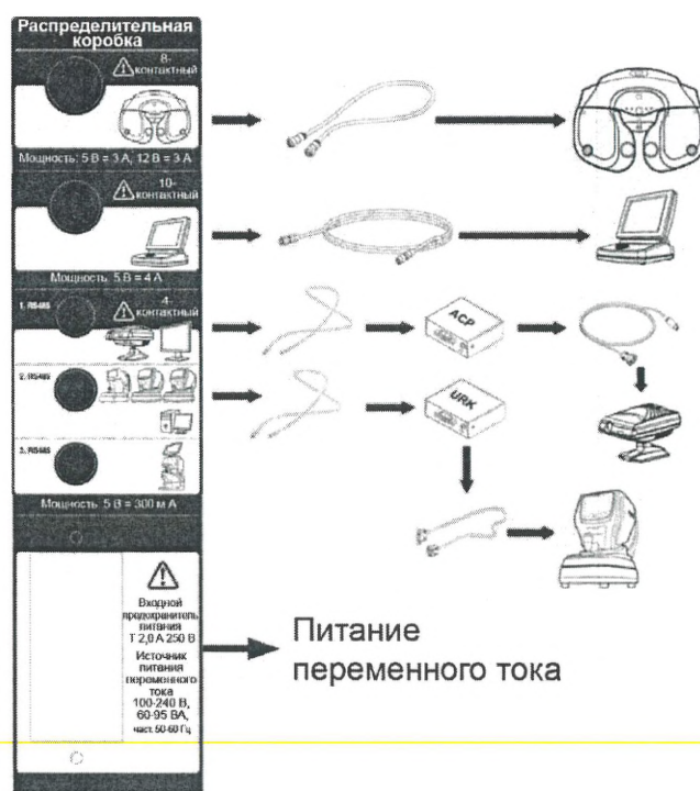
[Рисунок 4-11] Схема подключения UDR-800A
