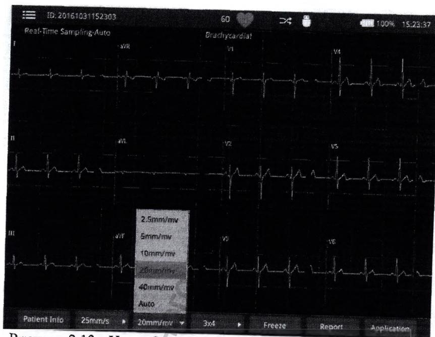
Рисунок 2.13 - Интерфейс переключения амплитуды усиления
